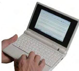
reless. Il processore è un Intel Celeron M ULV 353 da 900 MHz basato sul core Dothan con cache L2 ridotta a 512 kb capace di un consumo a pieno carico di soli 5 watt.
